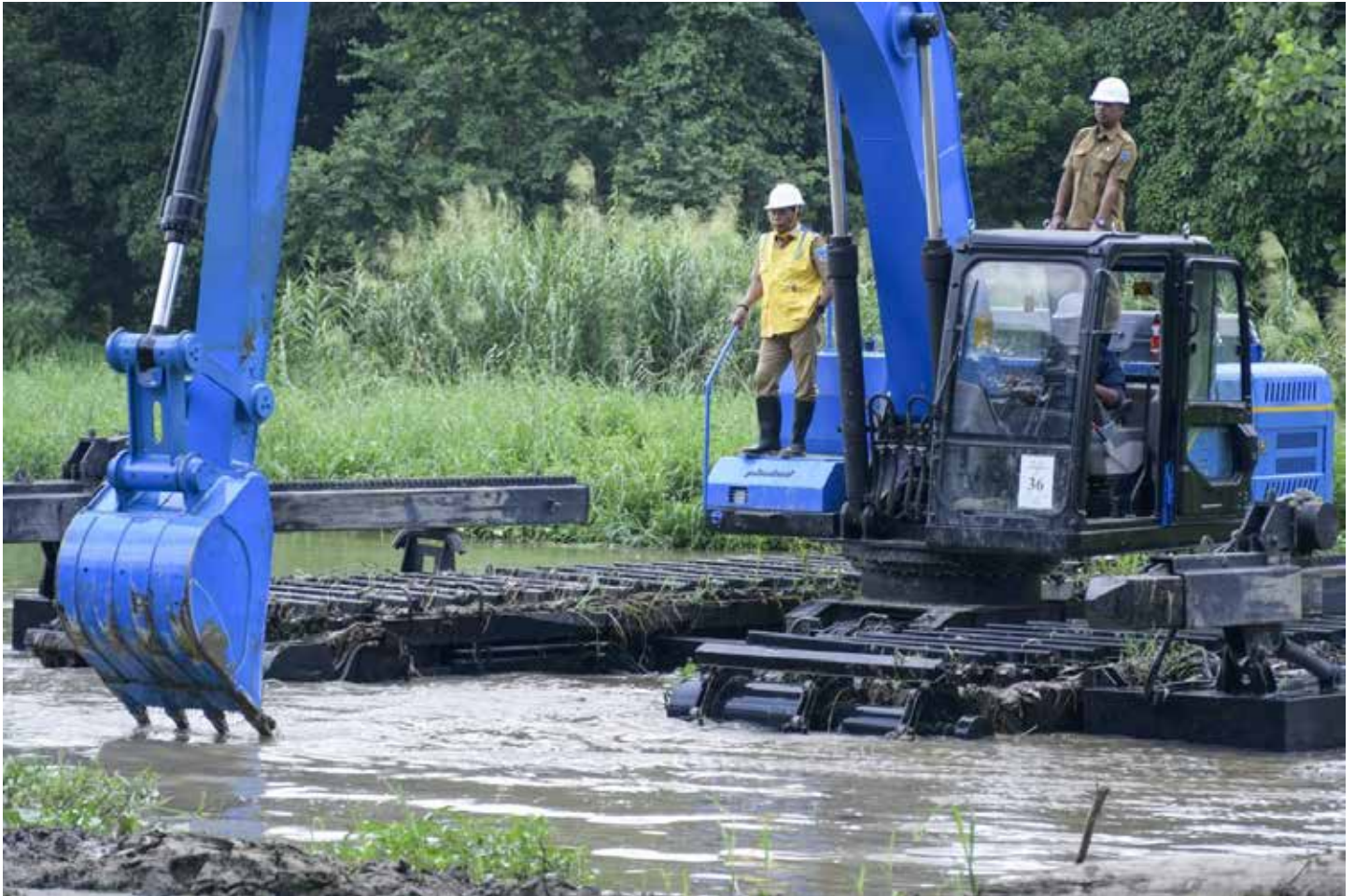
PASTIKAN RAMPUNG: Gubernur Kaltara Zainal Paliwang di atas excavator amphi long arm buatan PT. Pindad saat sedang melakukan pengerukan Sungai Selor di Tanjung Selor, Kabupaten Bulungan, Senin (21/8).
